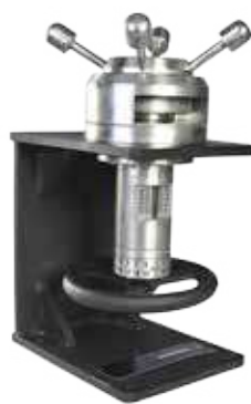
Misuratore di imbutitura Erichsen
