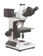
Microscopio metallurgico trinoculare verticale con ottica piana ed illuminazione a luce incidente. Particolarmente adatto per situazioni che richiedono una visuale verticale. Microscopio funzionale con nitidezza sorprendente.
