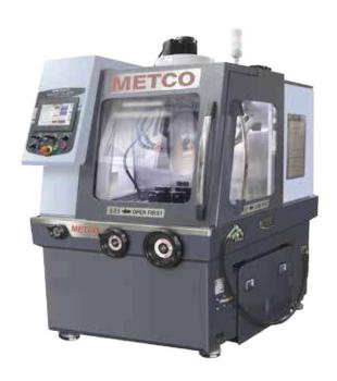
Troncatrice automatica extra large con sportello scorrevole. Movimento asse Y automatico standard, movimento asse Z automatico opzionale. Taglio a impulsi, taglio graduale, ecc., per evitare surriscaldamento. Parametri programmati per facilitare l'utilizzo.
