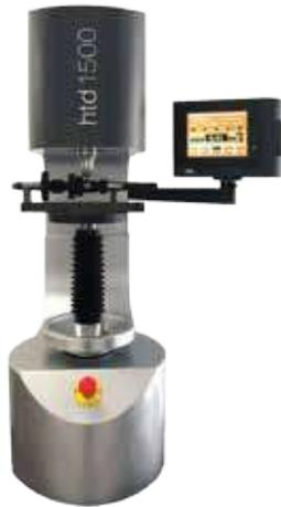
Quando la precisione nella misurazione della profondità del trattamento termico è fondamentale, HTD1500 e HTD4000 si distinguono come soluzioni innovative. Questi specifici durometri sono impiegati per la misura della profondità della durezza del trattamento termico offrono una rapida, accurata e non distruttiva verifica dello spessore fino a 1,3 mm (HTD1500) e 2,7 mm (HTD4000).
