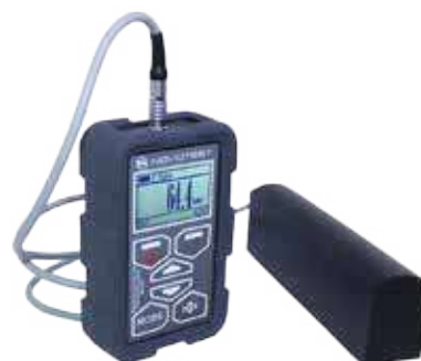
Misuratore di coperture in calcestruzzo
