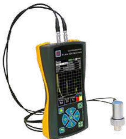
I rilevatori di difetti sono progettati per ricercare vuoti e disomogeneità all'interno dei materiali da testare con strumenti a ultrasuoni. È il dispositivo più comune per la prova non distruttiva di prodotti in metallo (e altri materiali con bassa attenuazione degli ultrasuoni) in produzione e in lavorazione.
