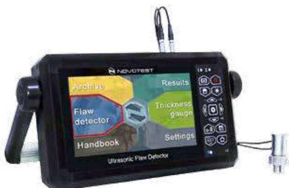
Il rilevatore di difetti a ultrasuoni **UD3701** è progettato per rilevare difetti interni, come discontinuità ed eterogeneità dei materiali in prodotti e saldature; determinare le coordinate e valutare i parametri dei difetti; misurare lo spessore e la velocità di propagazione e attenuazione delle onde ultrasoniche nei materiali (metalli, plastiche, vetro, ecc.); ricercare punti di corrosione, crepe, delaminazione interna e altri difetti.
